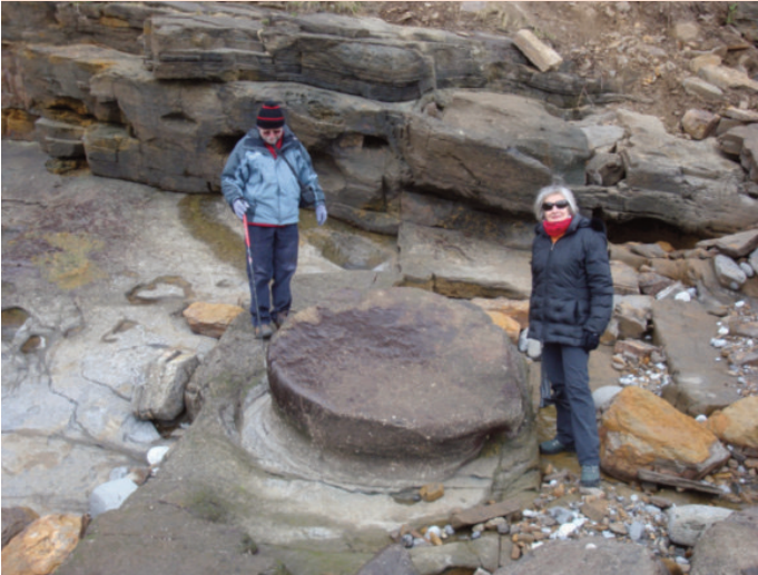
Foto DSC05917: Muela en fase de extracción de la roca matriz del acantilado.
