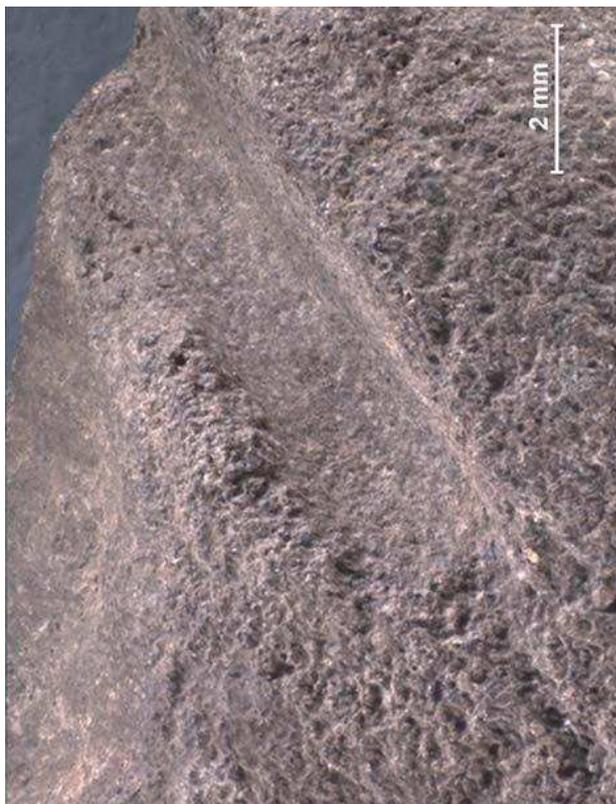
**Fig. 6.** Detalle de la superficie abrasionada de la ranura.
