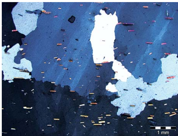
Fig. 1. Vista macroscópica general de la textura del cuarzo policristalino. Muestra extinción ondulante y abundantes inclusiones orientadas de pequeñas micas blancas tabulares. Ampliación x25.
