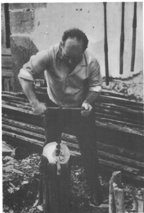
Fot. n.º 3. Haciendo el agujero con el «taratilu» para poder trabajar con los «errakiek».
