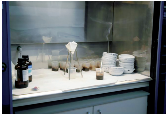
Figura 3. Campana de gases en la que se separaron los caparazones por flotación con líquidos pesados.
